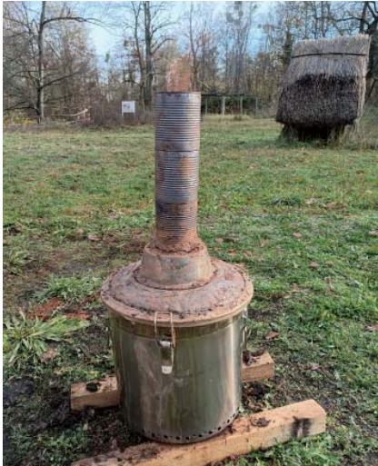
Die Pflanzenkohle wird in diesem Pyrolyseofen „Marke Eigenbau“ hergestellt und danach mit Nährstoffen angereichert.
