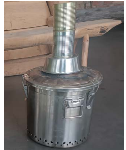
Im Workshop wird u.a. erklärt, wie man einen einfachen Pyrolyseofen selbst und kostengünstig bauen kann. Foto: atz Welzow
